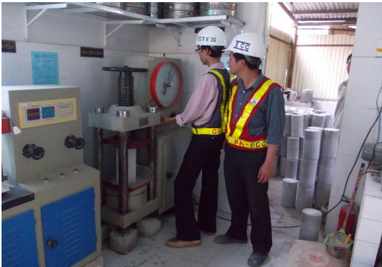
Thí nghiệm cường độ bê tông Dự án Nút giao thông khác mức Ngã Ba Huế
