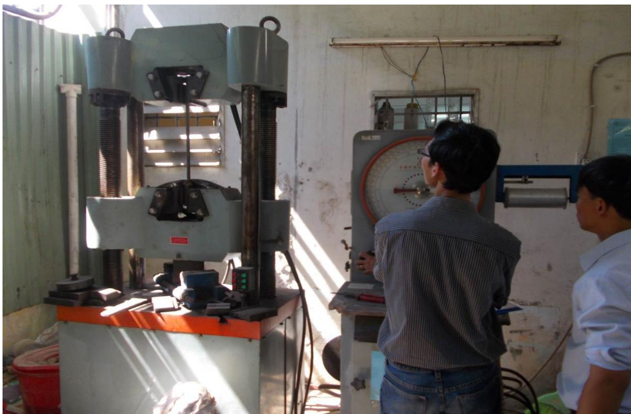
Thí nghiệm cơ lý thép Dự án Nút giao thông khác mức Ngã Ba Huế
