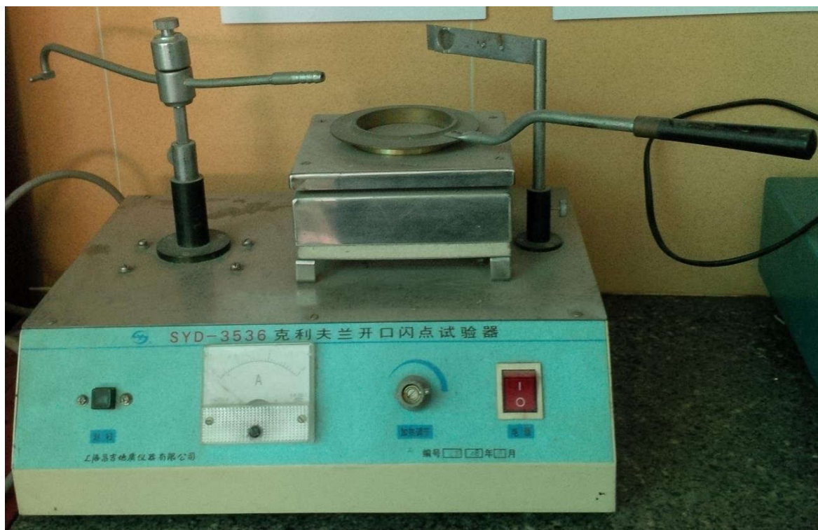
Máy xác định nhiệt độ bắt cháy bitum
