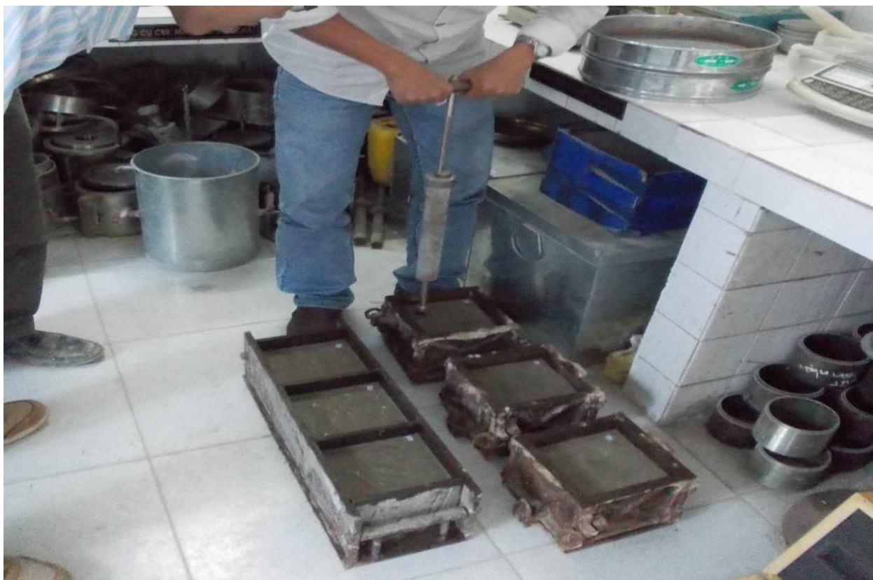
Thí nghiệm thời gian ninh kết của bê tông xi măng
